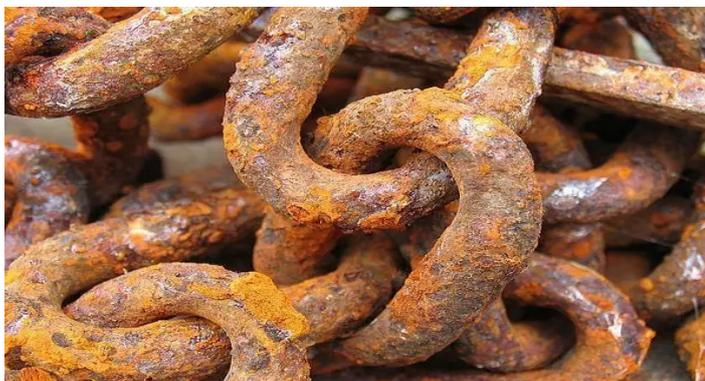
Nessa figura vemos o processo de ferrugem que ocorreu em uma corrente, antes essa corrente era formada por um elemento químico chamado de Ferro (símbolo Fe) devido a ação do tempo foi formado a ferrugem, que é o  $\text{Fe(OH)}_2$  (hidróxido de ferro II) é oxidado a  $\text{Fe(OH)}_3$  (hidróxido de ferro III), que é muitas vezes representado por  $\text{Fe}_2\text{O}_3 \cdot 3\text{H}_2\text{O}$ , pode-se perceber que houve mudança de substância, logo houve uma transformação química.
